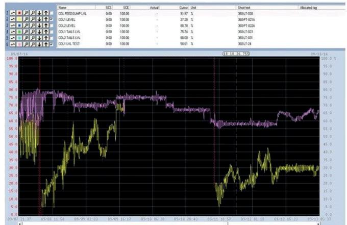
A sonda LTM não tem sua medição de nível afetada por adição de ar na polpa
